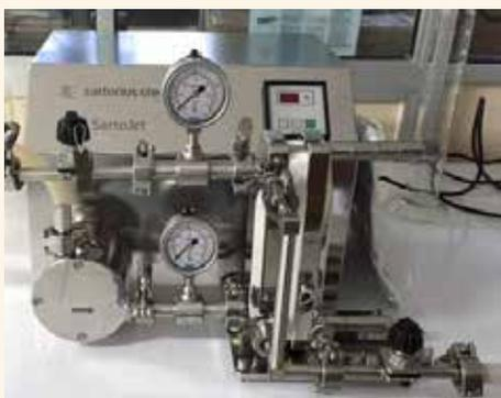
*Sartocon Slice* con membrana de microfiltración y bomba *Sartojet*
