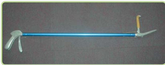
Figura 7. Pinzas largas metálicas de 1 m para capturar, levantar e inmovilizar a una serpiente.
