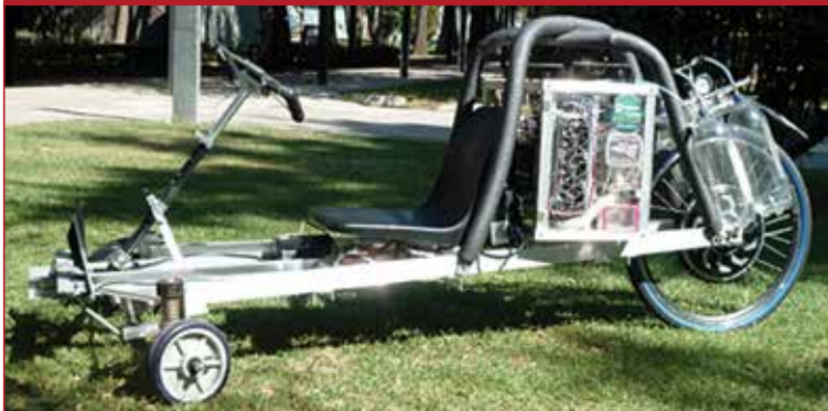
Figura 29. Vehículo “Nayaa” que opera con celdas que usan hidrógeno como combustible, prototipo del Instituto Politécnico Nacional, México, 2011
