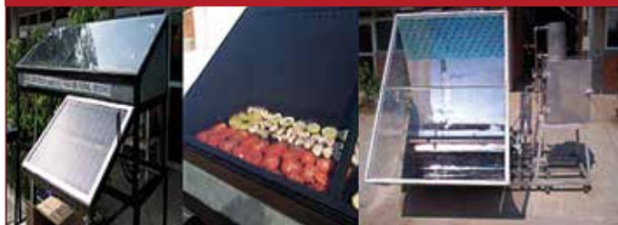
Figura 11. Secador solar y refrigerador solar intermitente, Instituto de Energías Renovables, UNAM, Temixco, Morelos
